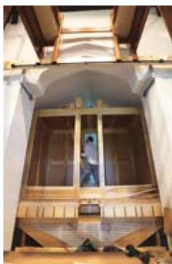
連続的な音量の変 化のためにパイプ 群を入れる箱（ス ウェル・ボックス） の中での作業
