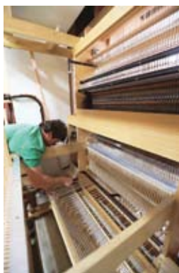
鍵盤とパイプの弁 をつなぐトラッカー の取り付け作業
